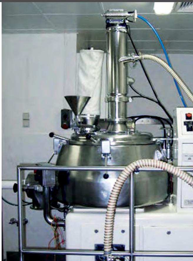
Alimentación del mezclador a través del PPC.
