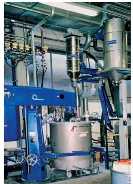
Transportador por vacío para el transporte de pigmentos para la fabricación de lacas.
