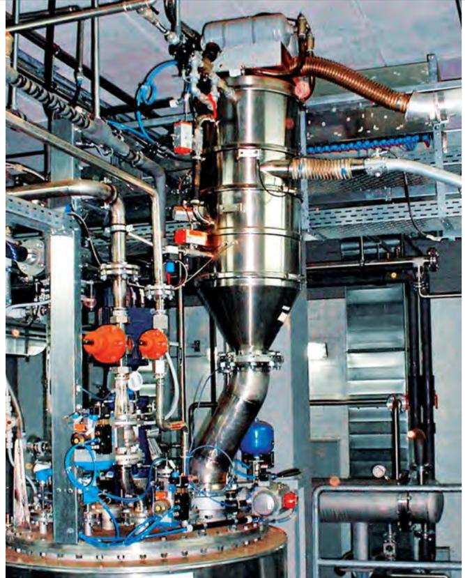
Transportadores por vacío con función de bloqueo para el transporte de pigmentos en una atmósfera de disolventes.
