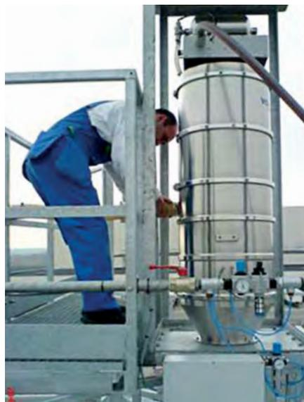
Transportadores por vacío en la instalación al aire libre para la alimentación de silos
