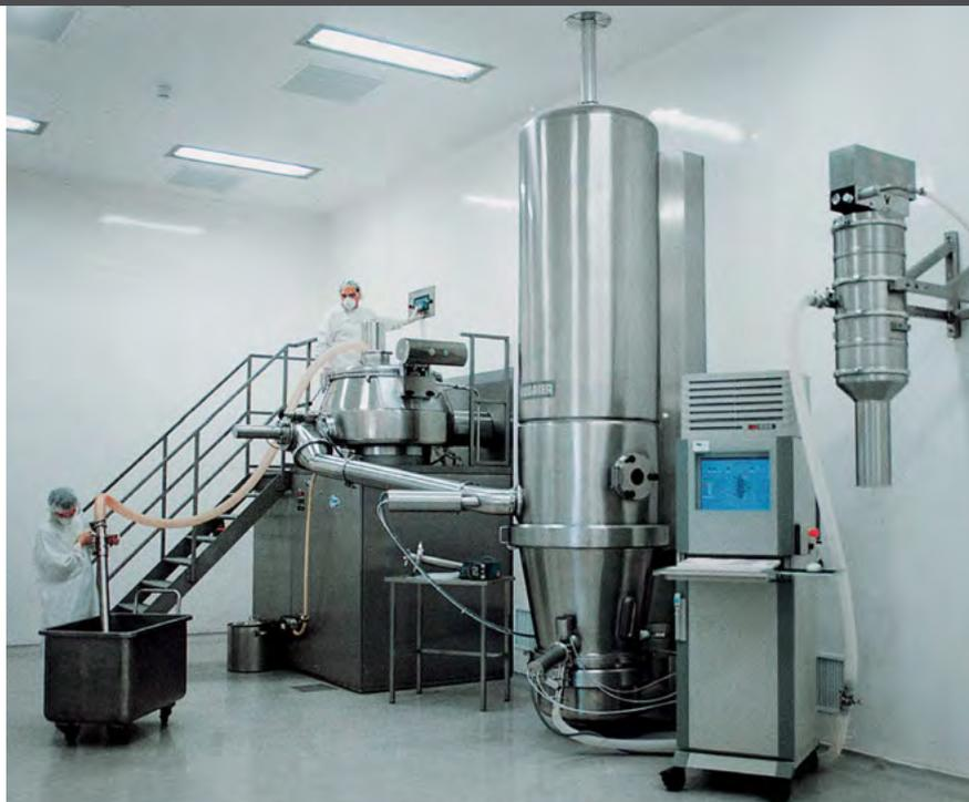
Transportadores por vacío para el vaciado automático de secadores de leche fluido.
