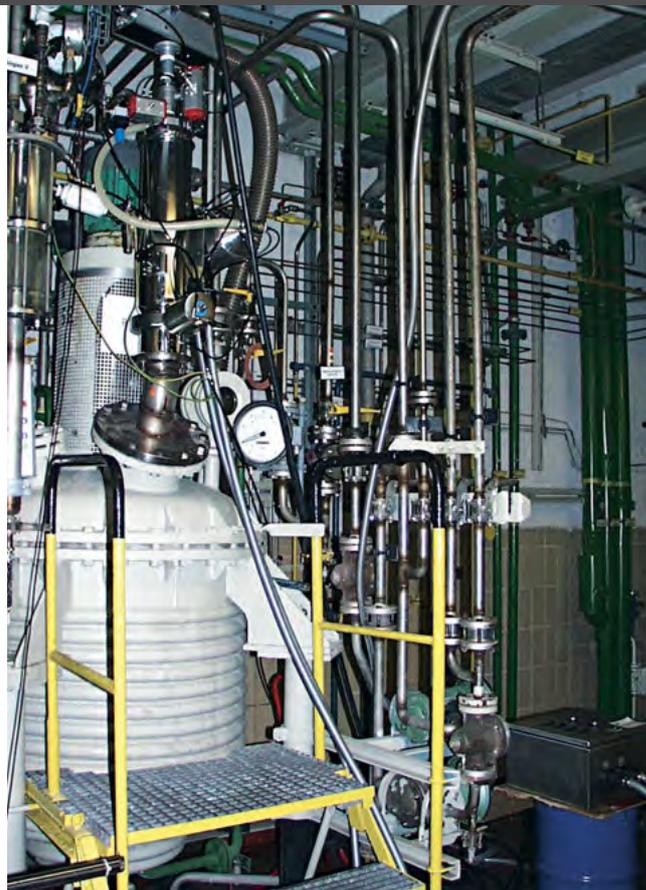
Con los transportadores por vacío VOLKMANN INEX, los materiales se transportan fácilmente y con seguridad en las plantas transportadoras donde la seguridad es crítica, tales como tanques agitadores y reactores. Permiten la transferencia de polvo en todas las zonas de explosiones de gas y polvo.
