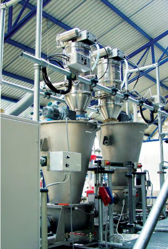
Dos transportadores por vacío para alimentación gravimétrica por pérdida de peso.
